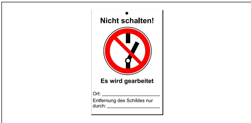
Abb. 12 Gerät gegen unbefugtes Wiedereinschalten sichern
